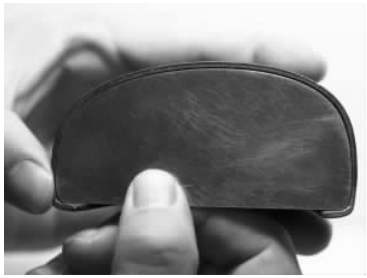
图 2 人工检查钢包头 Fig. 2 Manual inspection of steel toecaps
